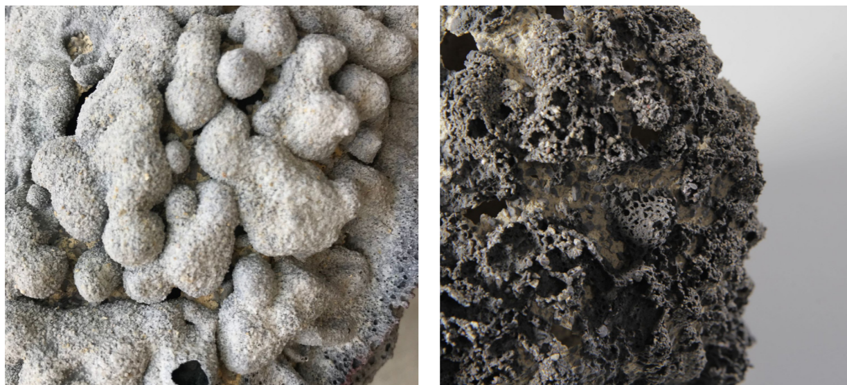
21. Próba z czarnego szkliwa lawowego wypalanego w pojemnikach z piaskiem kwarcowym o uziarnieniu 0,7-1,2 mm. Próbkę po wypaleniu została wypięskowana.
