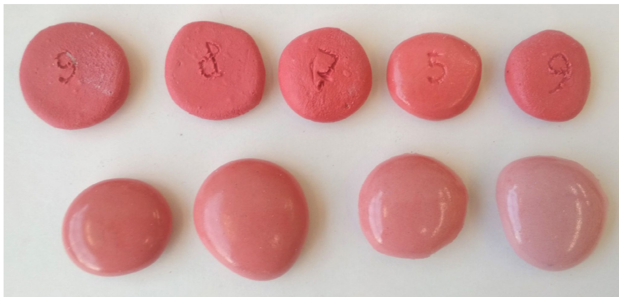
29. Te próbki pokazują, jak zmienia się masa gliny po dodaniu szkliva w różnych proporcjach.
