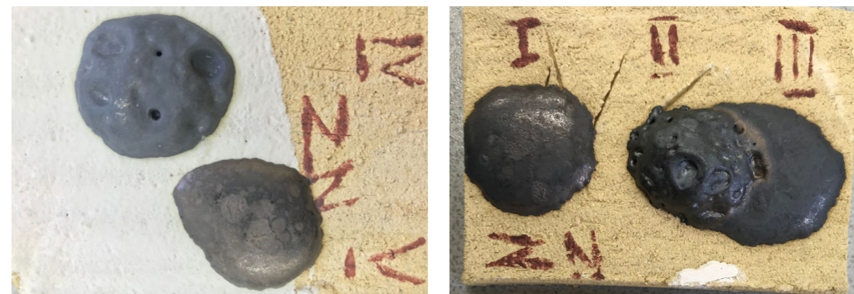
27. Kilka przykładów mieszanek, które przetestowałam poprzez dodanie tlenków metali, aby zmienić fakturę powierzchni.
