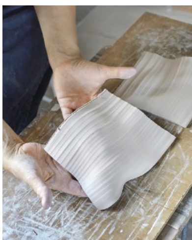
Zdjęcie 48. Proces powstawania kształtki, dopasowanie rozmiaru pasa gliny.
