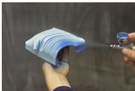
Zdjęcie 8. Pracownia w galerii. Nakładanie angoby aerografem.
