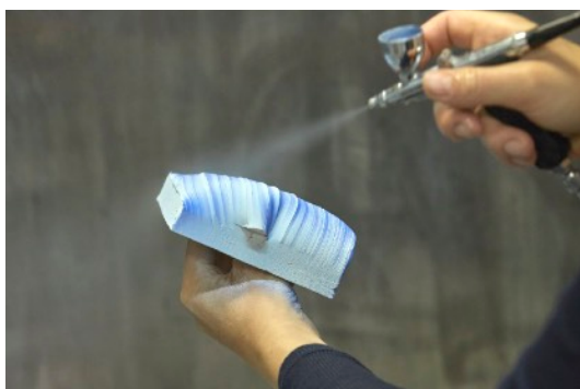
Zdjęcie 7. Pracownia w galerii. Nakładanie angoby aerografem.
