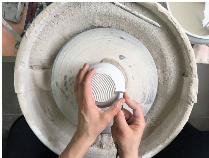
Zdjęcie 26. Obtaczanie stopy na sucho. Pracownia.
