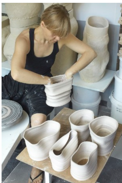
Zdjęcie 46. Proces powstawania kształtki, toczenie na kole garncarskim.
