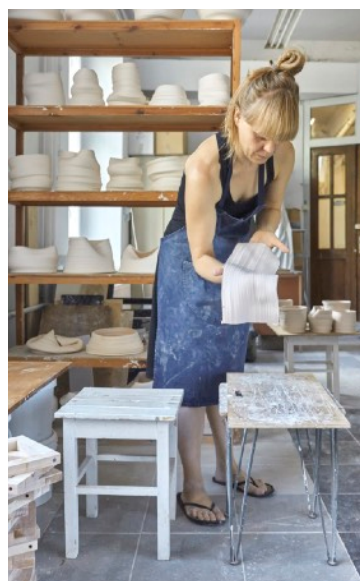
Zdjęcie 47. Proces powstawania kształtki, rozciniwanie walca.
