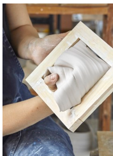
Zdjęcie 49. Proces powstawania kształtki, umieszczanie wytoczonej gliny w formie.
