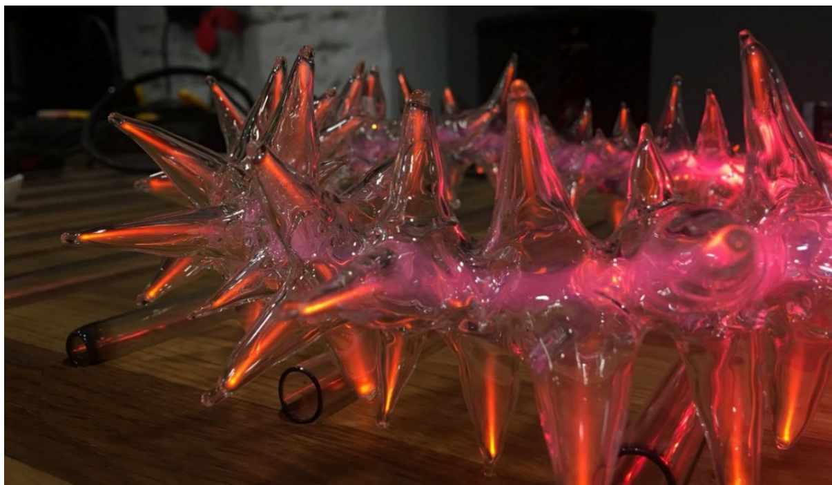
Ilustracja 13. Przykład wykorzystania wpływu jaki wywiera geometria oraz grubość warstwy gazu na intensywność emisji wtórnej z cząsteczek oblepiających wewnętrzne szklanej formy. Widoczne charakterystyczne gradienty i zwiększona intensywność emisji w uchylkach o najmniejszym przekroju.
