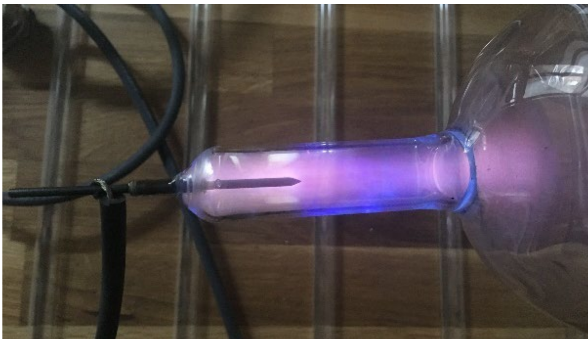
Ilustracja 11. Elektroda o bardzo małym promieniu, zaostzona.
