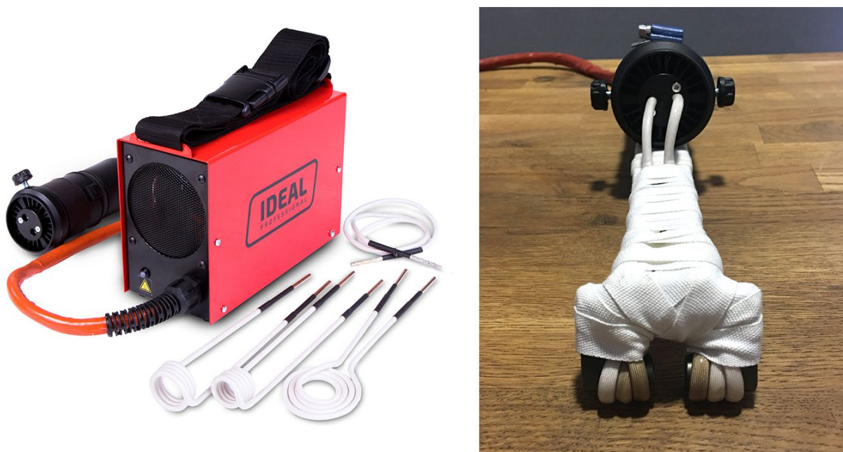
Ilustracja 20. Po lewej stronie podgrzewacz indukcyjny Ideal Inductor 1.5kW. Po prawej stronie specjalnie dostosowana cewka wykonana samodzielnie.
