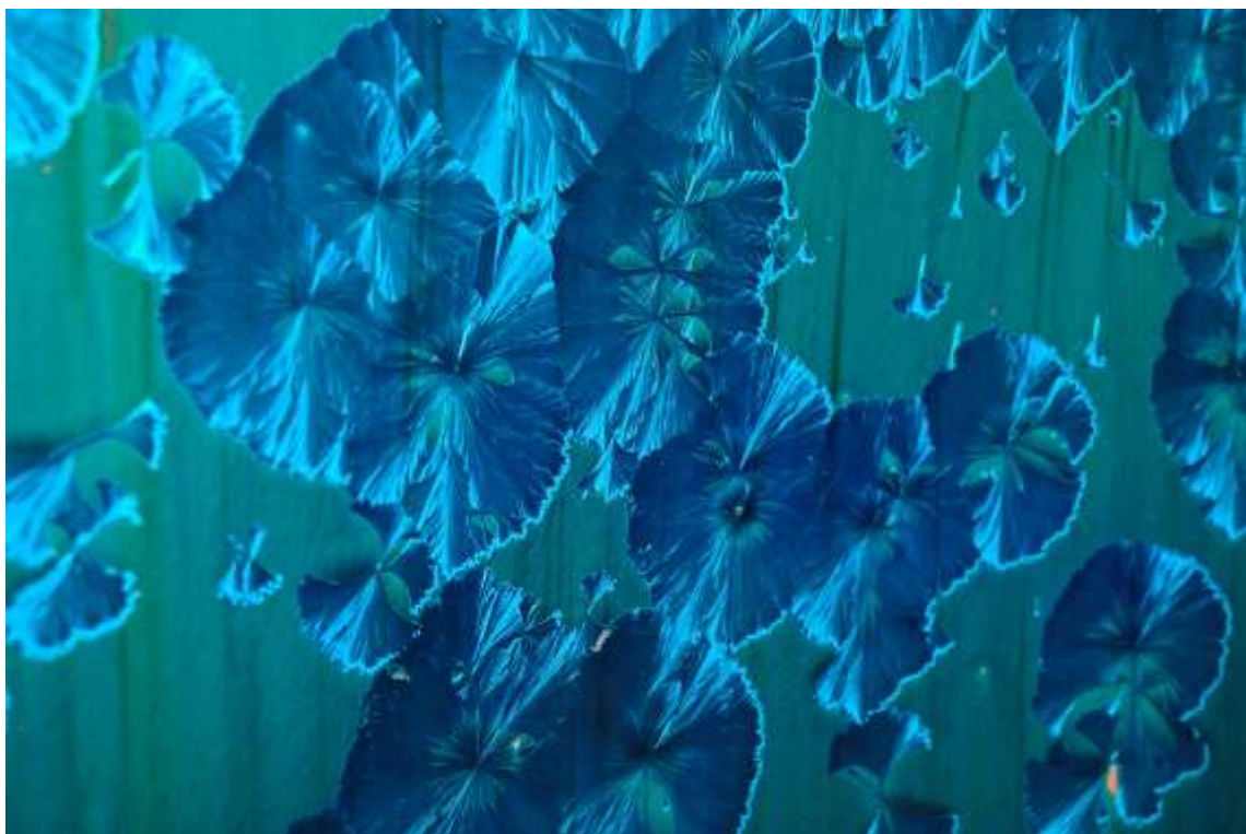
Il.38. Detal autorskiego szkliwa krystalicznego. Szkliwa te, można klasyfikować na podstawie wielkości (makro, mikro). Różnią się również kształtem. Kryształy z opracowanej przeze mnie receptury formowały się zarówno w postaci igieł, jak i całkowicie zaokrąglonych kryształów, które dają wyraźnie kwiatowy efekt. Źródło własne
