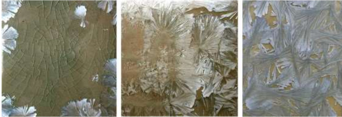
Il.33. Próby szkliv krystalicznych powstałe z bazowej mieszanki (50% Ferro 3110, 25% ZnO, 25% SiO 2 ). Źródło własne
