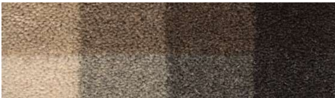
Il. 28. Karta techniczna jakości- Natural (tkanie maszynowe Axminster): Skład okrywy runowej- 100% wełna niebarwiona brytyjska, Wysokość runa 12 mm ,Ilość punktów na metr2 173 880, Waga całkowita (kg/m2) 2,80 , Kolory: Cream, Light Beige,Light Grey, Dark Beige, Grey,Brown,Dark Grey,Graphite. Źródło własne
