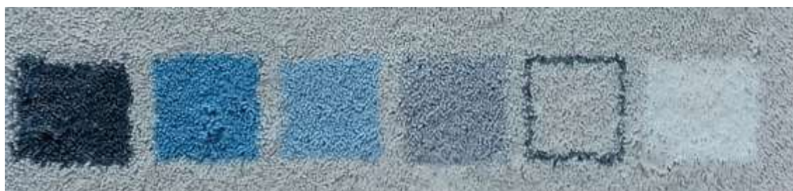
Il.31. Karta techniczna jakości Diamond (tkanie maszynowe Wilton): Skład okrywy runowej- 100% wełna nowozelandzka ,Wysokość runa 13 mm ,Ilość punktów na metr 2 662 400 , Waga całkowita (kg/m 2 ) 3,70, Kolory: Blue, Light blue, White shrink, grey, polar white, beige. Źródło własne
