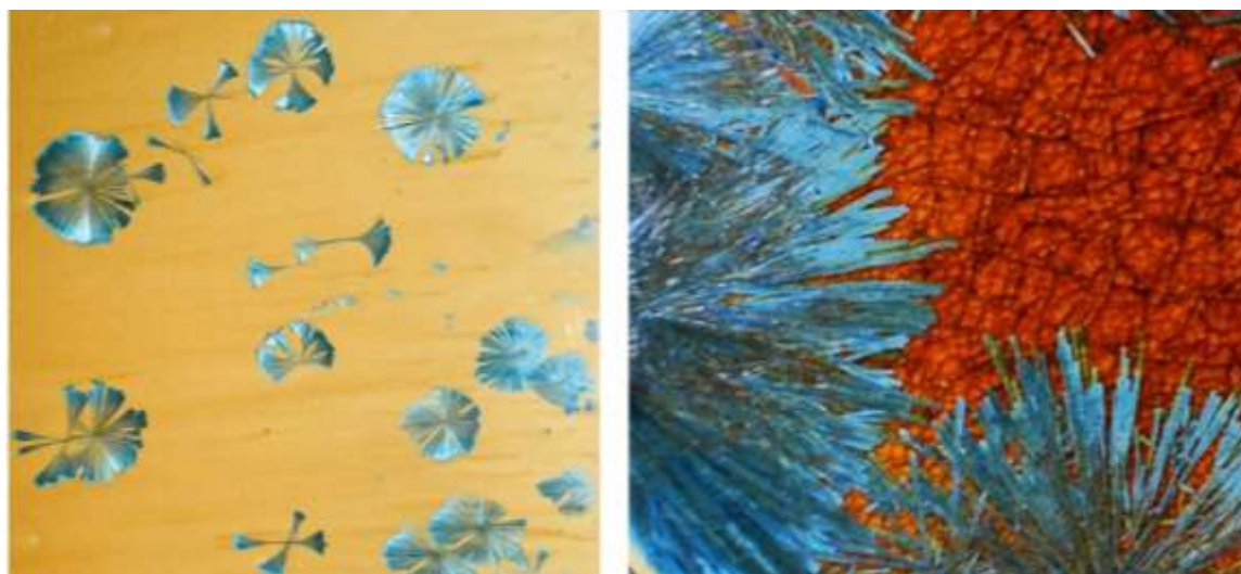
il.35. Próby szkliv krystalicznych o składzie: spodumen 4%,talk 2%, dolomit 2%, węglan litu 2%, dwutlenek tytanu 1 %,ferro 45%, tlenek cynku 25%, krzemionka 19% barwione tlenkiem niklu (kolejno 2%,6%). Źródło własne
