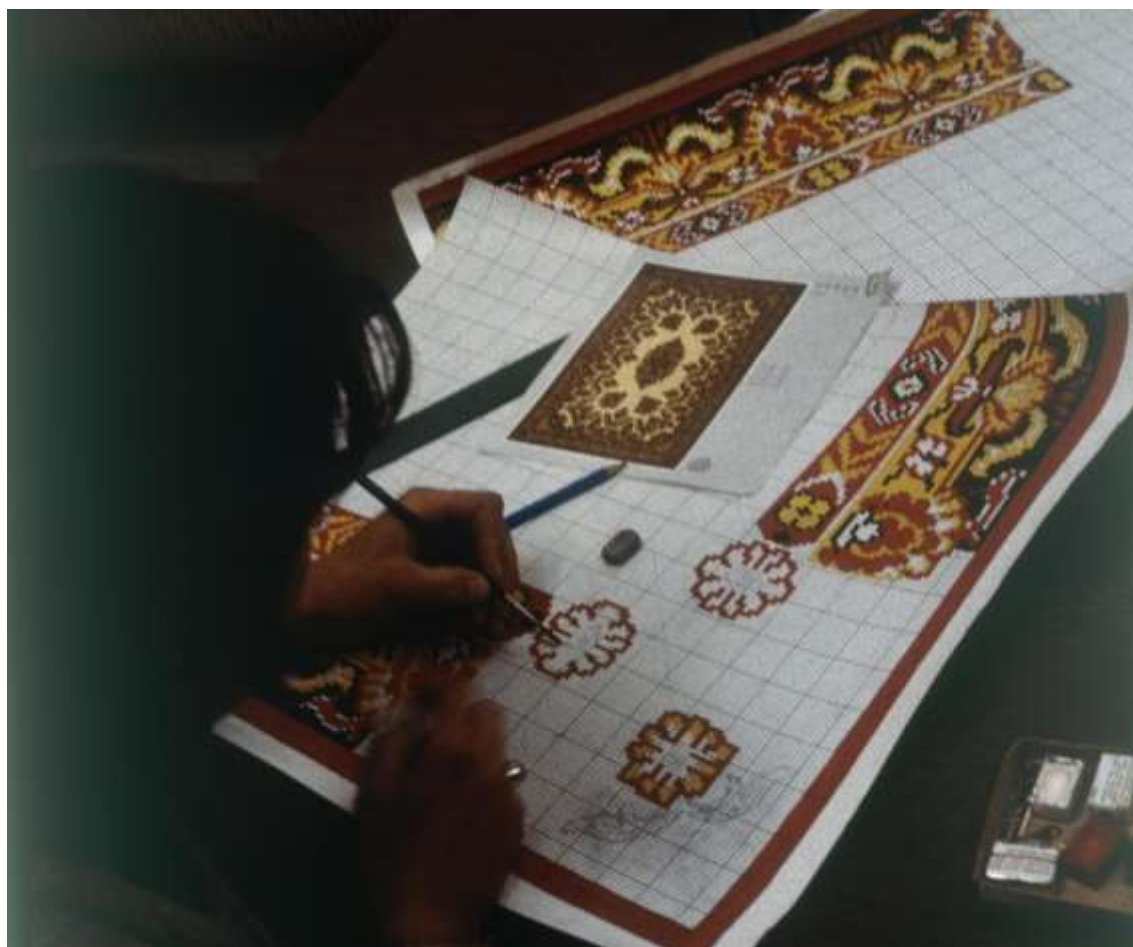
Il.17. Wzory powstawały przez mozolne wypełnianie kolorem punktów na kratkownicy tkackiej. Według rysunku technicznego wybijać wzoru wykonywał wzornicę, która tworzy na krosnie wzór dywanu. Źródło: Narodowe Archiwum Cyfrowe.
