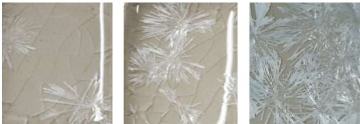
Il.40. Zdjęcie obrazujące próby szkliw z różnych ujęć wody (kolejno z : wody miękkiej, wody twardej, wody destylowanej). Źródło własne
