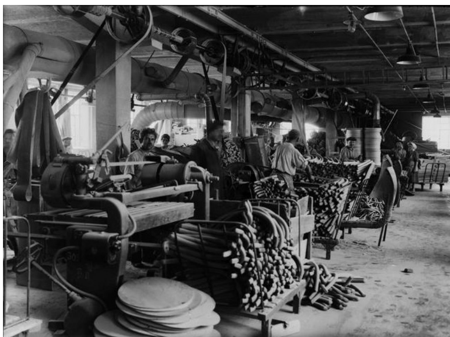
Produkcja mebli giętych z drewna bukowego metodą hydrotermiczną, https://www.urzadzamy.pl/galeria/meble-thonetowskie-kultowe-meble-giete-jak-to-sie-zaczeo/gg-jZbM-ugMe-fyhH/gp-eiEm-cttp-HKLT , fotografia domena publiczna.
