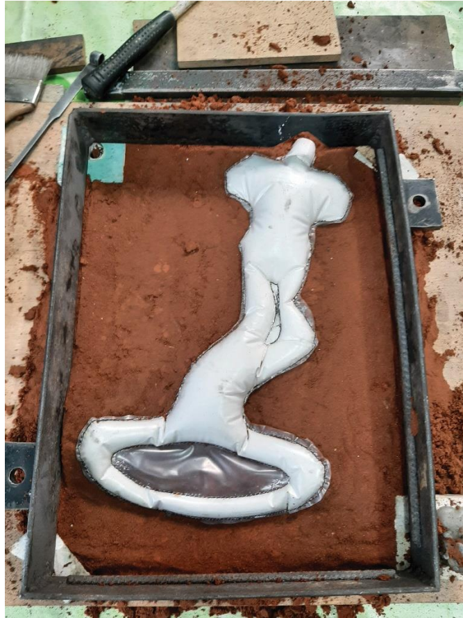
47. Model w formie skrzynkowej (formowanie na mułek formierski)
