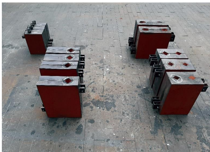
48. Modele w formach skrzynkowych (formowanie na mułek formierski)
