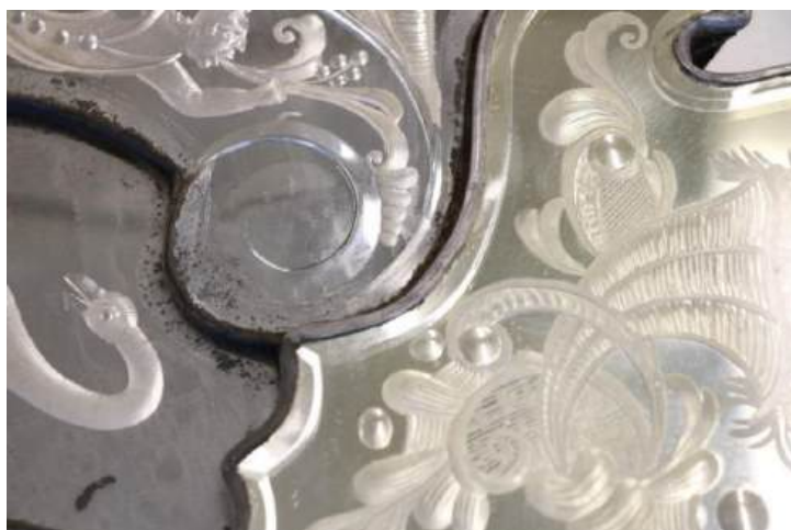
Fot. 140. Widoczne różnice w odcieniu tafli srebrzonej (po prawej) oraz tafli z amalgamatem cynowo-rtęciowym (po lewej) (własność Muzeum Narodowego we Wrocławiu, nr inw. MNWr II – 722), fot. N. Moszak
