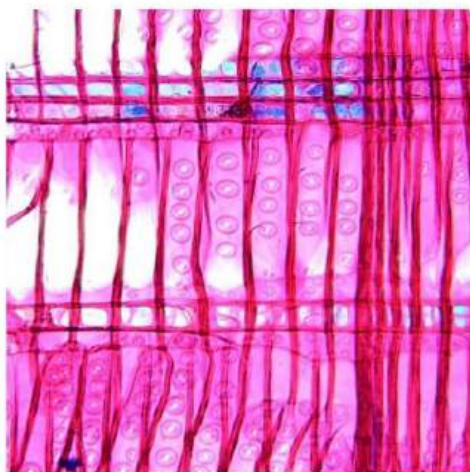
Fot. 7. Lustro weneckie MJG1245Ps Próbka nr 1. Sosna zwyczajna ( Pinus sylvestris L.) Przekrój promieniowy. Widoczne promienie niejednorodne z jamkami okienkowymi w polach krzyżowych.
