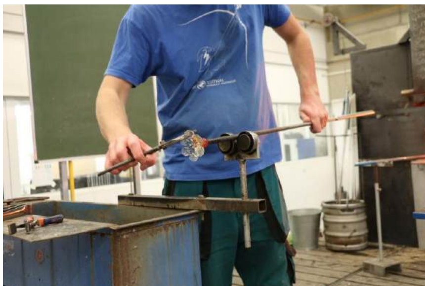
Fot. 117. Próby rekonstrukcji czteropłatkowego kwiatka barwionego grysem różowym, fot. N. Moszak
