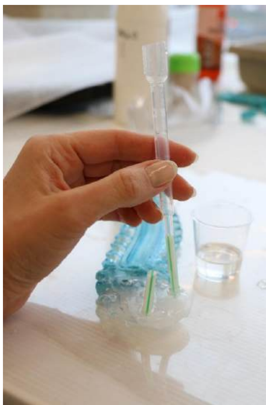
Fot. 105. Odlewanie uzupełnienia z żywicy epoksydowej z wykorzystaniem plastikowej pipety, MJG 36s, fot. N. Moszak
