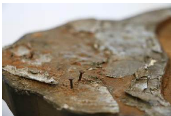
Fot. 76. Żelazne gwoździe korodujące w podłożu drewnianym zwierciadła MJG 1245Ps, fot. N. Moszak
