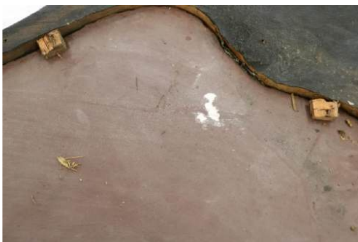
Fot. 50. Odwrocie zwierciadła MJG 1245Ps, montaż głównej tafli za pomocą żelaznych gwoździ i odpowiednio dociętych, kawałków korka, fot. N. Moszak
