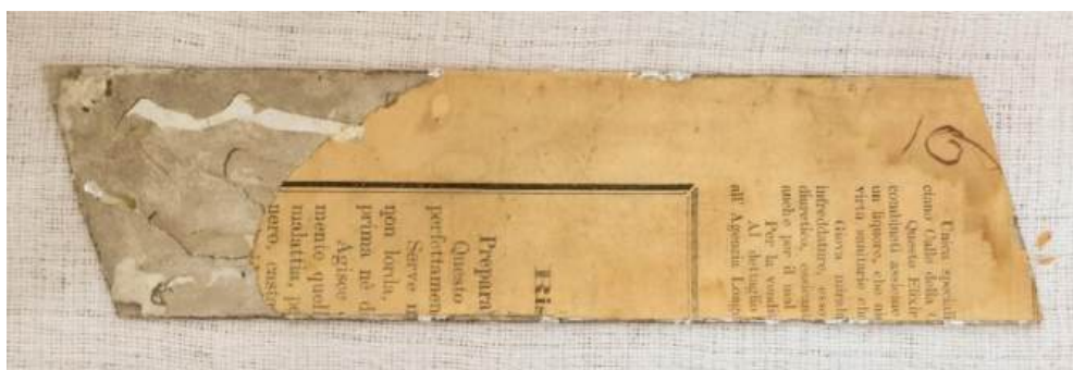
Fot. 146. Przykład odwrocia szkła pokrytego amalgamatem cynowo–rtęciowym zabezpieczonego wycinkiem włoskiej gazety, widoczne zacieki spowodowane obecnością ciekłej rtęci, własność: Muzeum Narodowe we Wrocławiu, fot. N. Moszak
