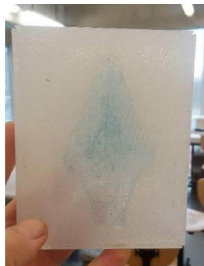
Fot. 123. Forma silikonowa do odlewu z żywicy na bazie metakrylanu metylu, fot. N. Moszak
