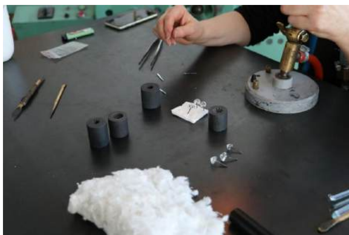
Fot. 122. Rekonstrukcja szklanych główek gwoździ i wkrętów w pracowni palników ASP we Wrocławiu, widoczne formy grafitowe, fot. N. Moszak
