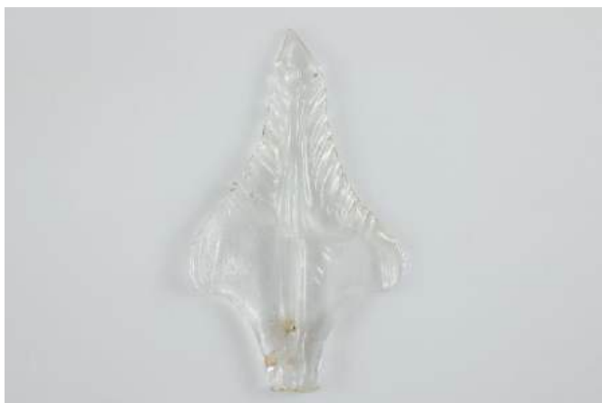
Fot. 107. Uzupelnienie szklanego liścia za pomocą żywicy epoksydowej, białe tło, światło rozproszone, MJG 36s, fot. N. Moszak
