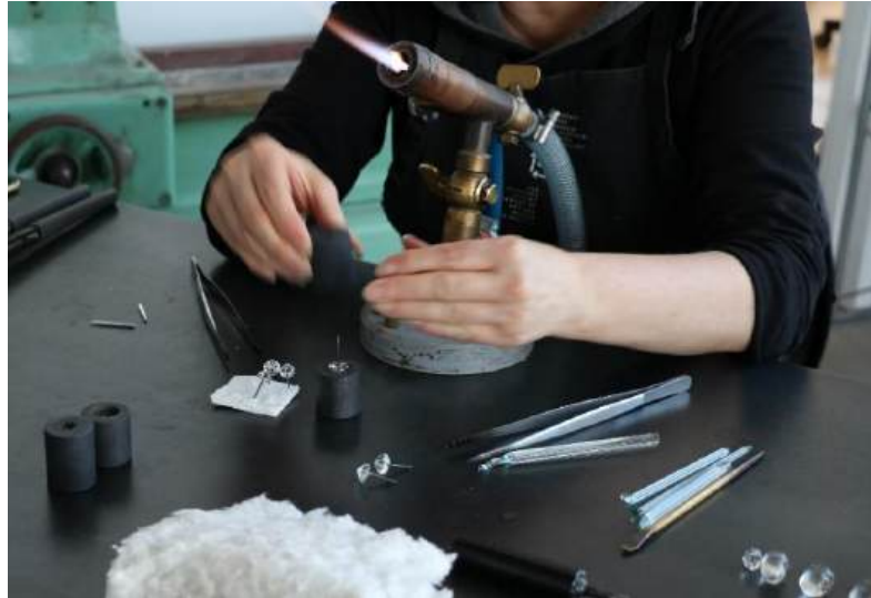
Fot. 59. Formowanie szklanych główek wkrętów i gwoździ za pomocą form grafitowych w ogniu palnika gazowego, fot. N. Moszak
