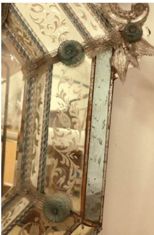
Fot. 147. Szkoło pokryte amalgamatem cynowo–rtęciowym dodane prawdopodobnie w wyniku późniejszych prac naprawczych obok szkła pokrytego metalicznym srebrem, widoczne zacieki spowodowane obecnością ciekłej rtęci, własność: Muzeum Narodowe we Wrocławiu, fot. N. Moszak
