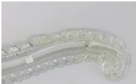
Fot. 99. Przykład żółkniętej żywicy epoksydowej Hxtal NYL-1, fot. N. Moszak
