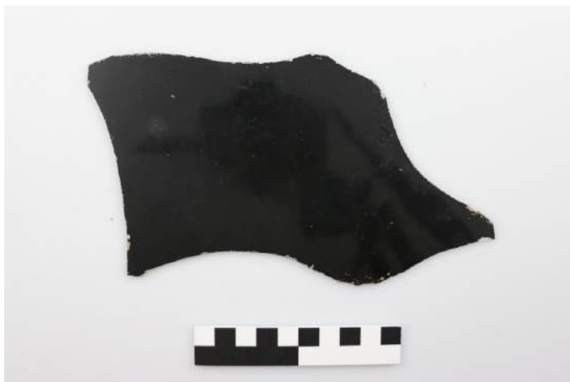
Fot. 57. Warstwa lakieru pokrywająca srebrzenie tafli, MJG 1245Ps, fot. N. Moszak
