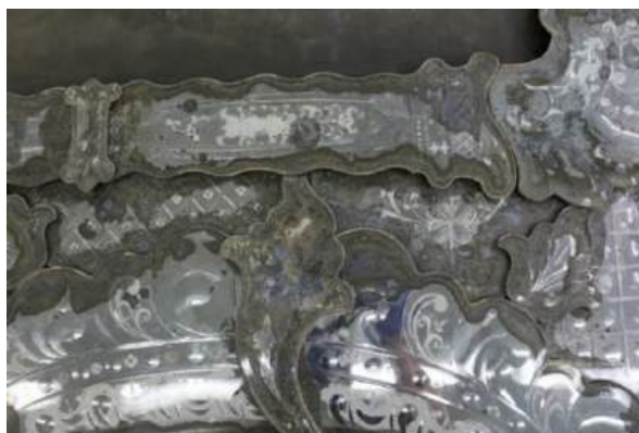
Fot. 144. Korozja tafli z warstwą amalgamatu, rama/retabulum ołtarzowe pochodzące z kościoła p.w. Narodzenia Najświętszej Maryi Panny w Wichrowie (1750-60 r.), fot. N. Moszak
