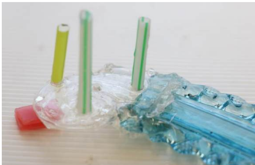
Fot. 104. Forma silikonowa do uzupełnień szkła, MJG 36s, fot. N. Moszak
