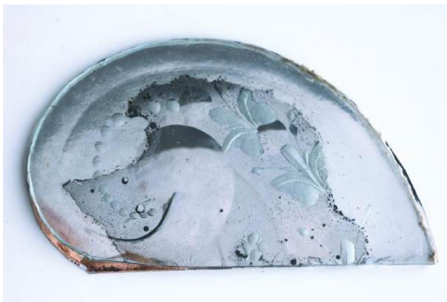
Fot. 127. Przykład zastosowania metalicznej folii polimerowej w tafli pokrytej amalgamatem cynowo–rtęciowym, fot. N. Moszak
