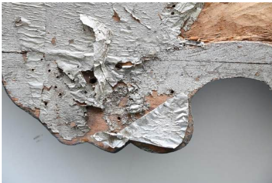
Fot. 84. Warstwa folii aluminiowej nałożonej na oryginalną folię cynową, prawdopodobnie podczas późniejszych renowacji, MJG 1245Ps, fot. N. Moszak
