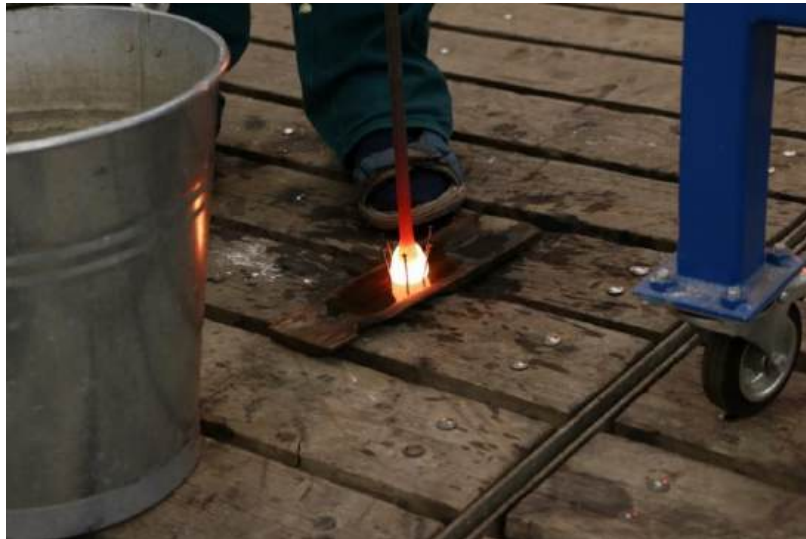
Fot. 114. Próby rekonstrukcji czteropłatkowego kwiatka barwionego grysem różowym, opuszczanie porcji szkła na tzw. „przedformę” fot. N. Moszak
