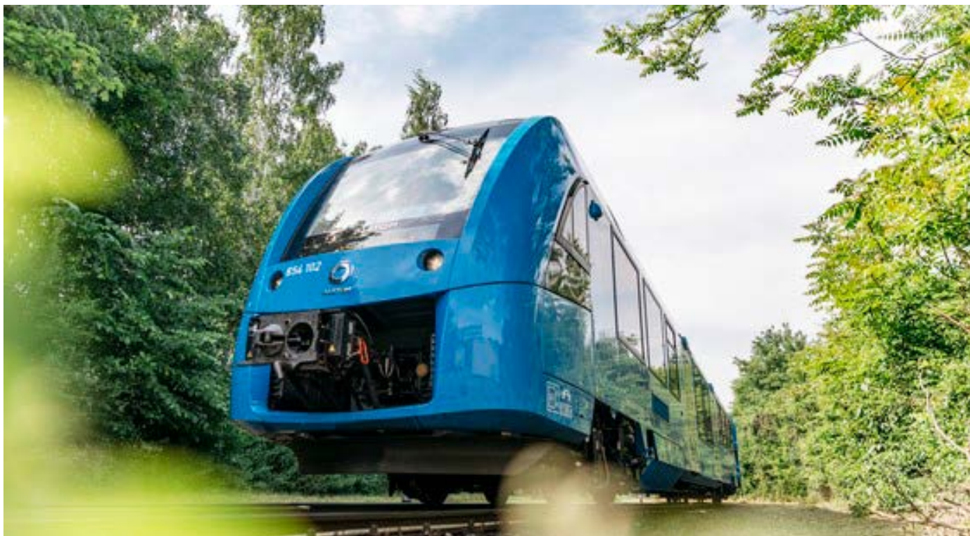
Ilustracja 21 EZT Alstom Coradia iLint wykorzystujący napęd wodorowy.
