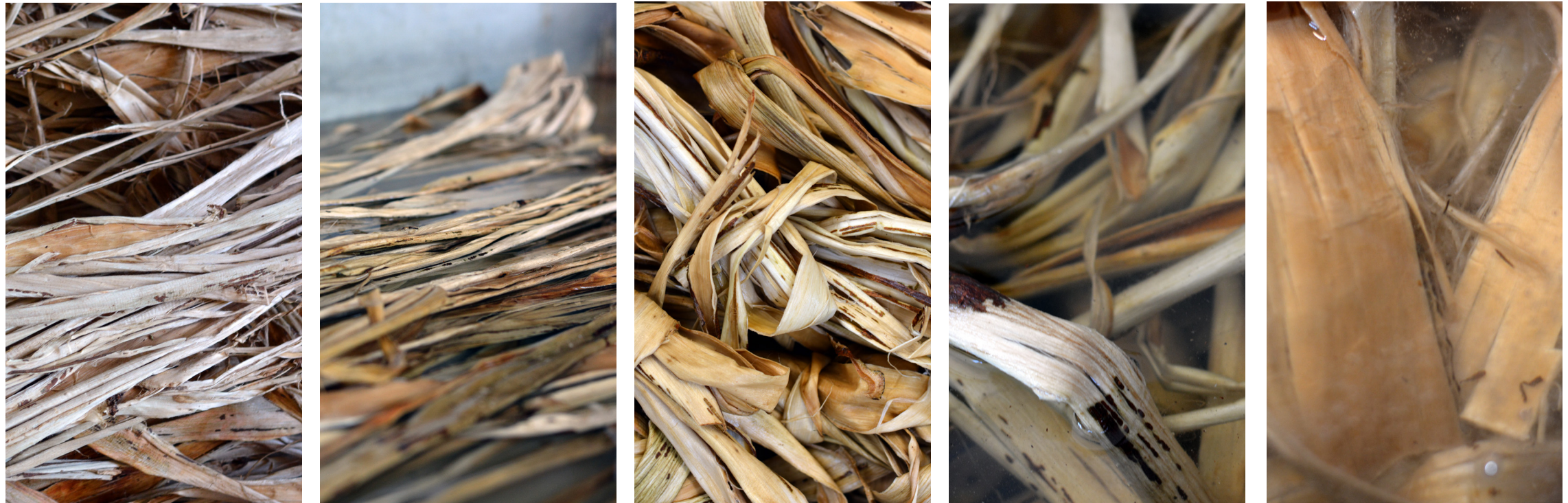
Wygląd kozo na różnych etapach przetwarzania, od lewej: suche łyko, łyko w trakcie moczenia, wymoczone, w trakcie gotowania, włókno po wygotowaniu w roztworze zasadowym
