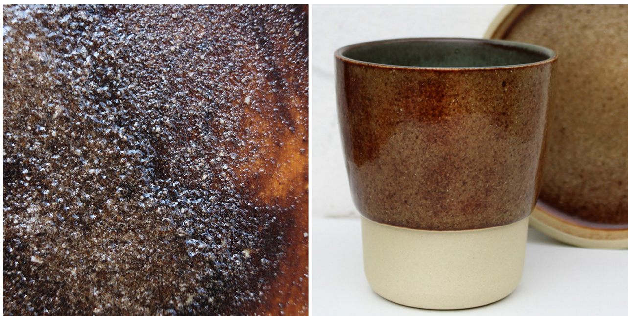
19. i 20. Próbką i naczynie pokryte szklivem z korzenia kozłka lekarskiego, archiwum własne.
