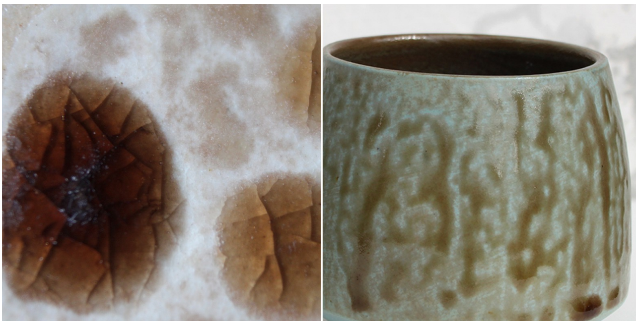
9. i 10. Próbką i naczynie pokryte szklivem z popiołu z eukaliptusa, archiwum własne.
