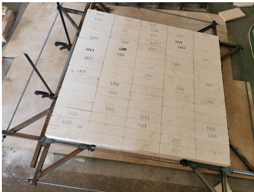
II.2.6. Pokrywa pieca z zastosowaniem metalowych narożników
