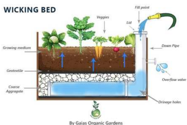
Rys.5.1.12. Schemat działania hydroponicznego systemu wicking bed .
