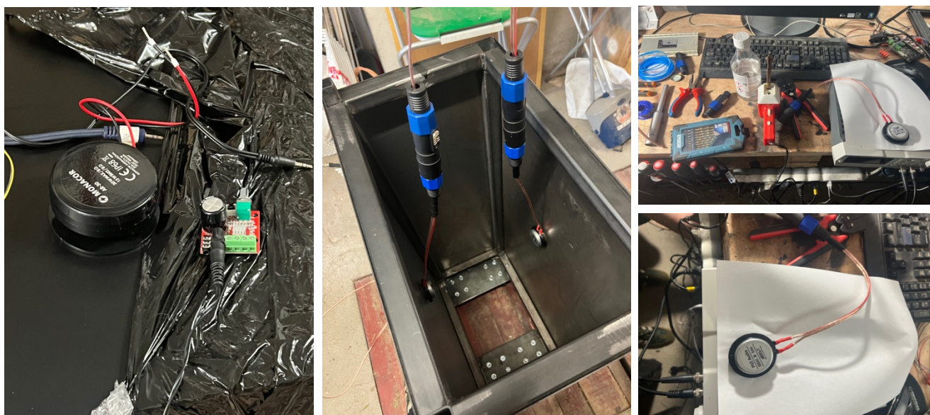
Figure 20 Umieszczenie przetworników (exciterów) wewnątrz stalowej konstrukcji. Urządzenia zostały zamontowane bezpośrednio na wewnętrznych panelach i połączone z zewnętrznym wzmacniaczem, co przekształciło monolit w rezonujące, wibracyjne ciało.
