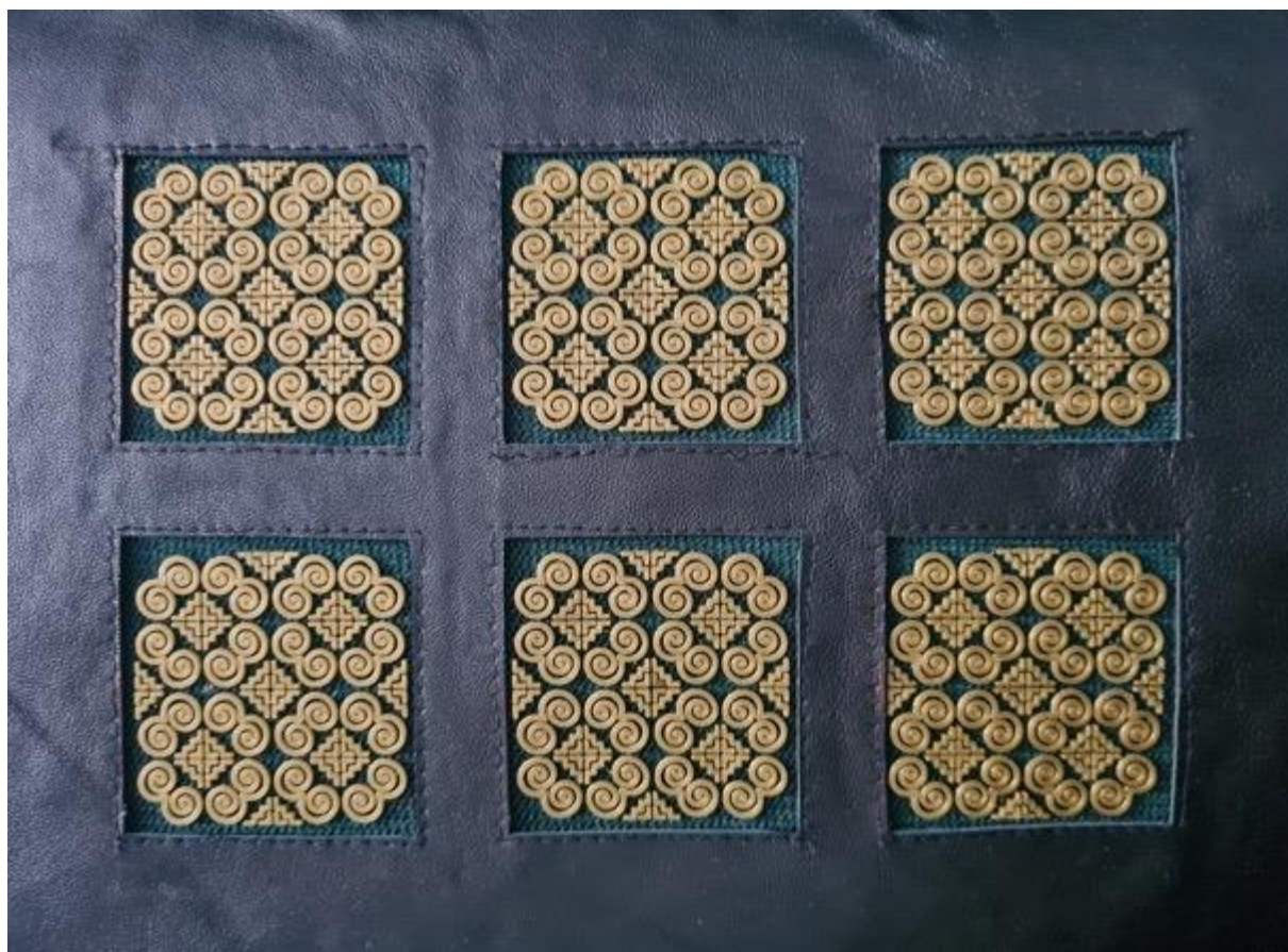
Fot. 81. Przykład połączenia dwóch technologii: druku 3D i wycinania laserem skóry naturalnej cielęcej
