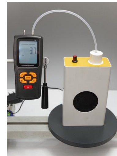
Zdj. 202. Pomiar ciśnienia statycznego.
