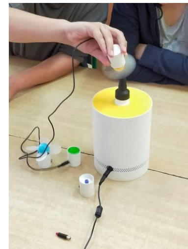
Zdj. 169. Wykorzystanie energii wiatru do napędu silnika wibracyjnego.
