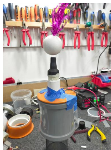
Zdj. 176. Badanie komory wentylatora.
