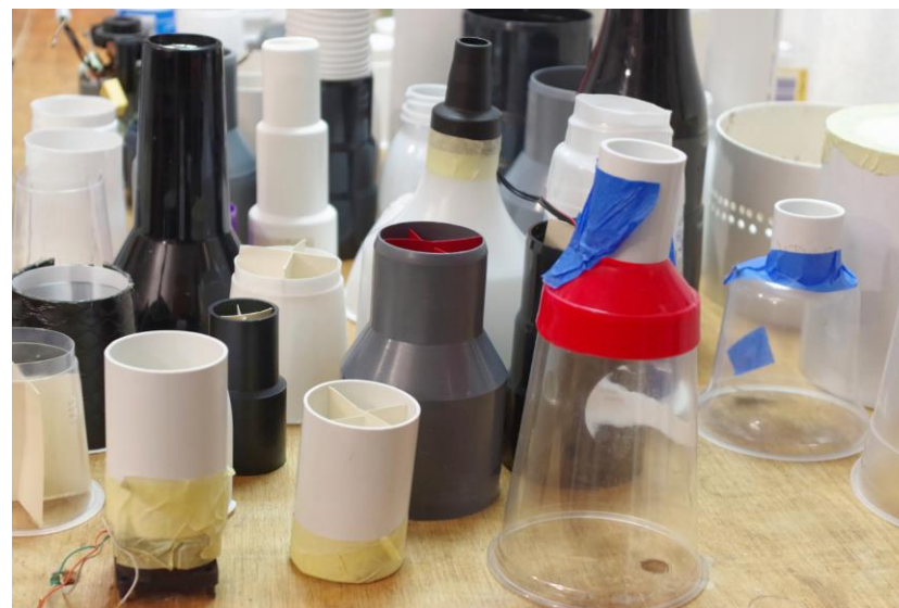
Zdj. 175. Elementy do badania wpływu formy komory na ciśnienie dynamiczne strugi.
