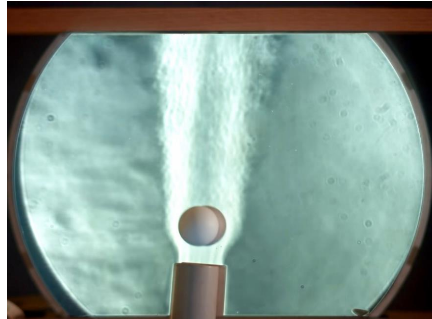
Zdj. 11. Piłeczka w strumieniu powietrza suszarki do włosów. Obrazowanie smugowe wykorzystujące optykę Schlieren.
