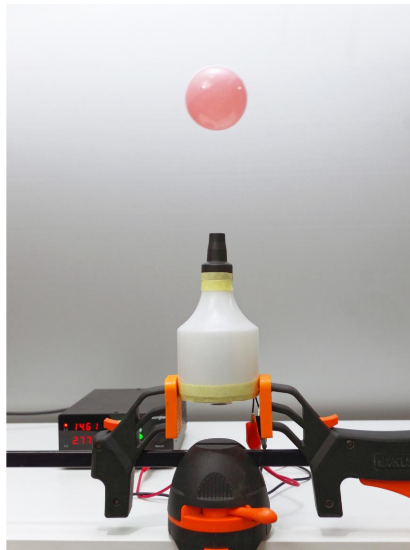
Zdj. 50. Przykład badania wentylatora odkurzacza akumulatorowego pod kątem uzyskiwanego ciśnienia, napięcia zasilającego i poboru mocy.
