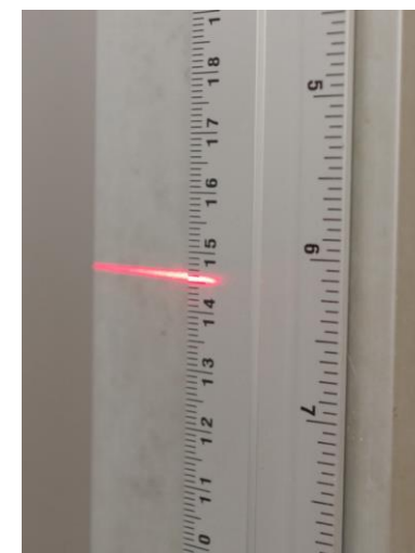
Zdj. 182. Odczyt śladu lasera na skali.
