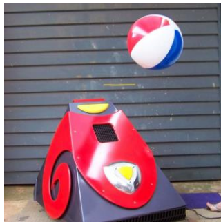
Zdj. 31. Bernoulli Blower Machine, RPA.
