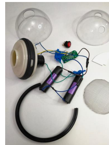
Zdj. 126. Widok wszystkich elementów dmuchawy.
