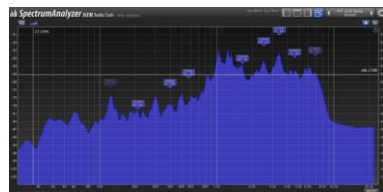
Zdj. 216. Widmo akustyczne dmuchawcy nr 7 po wygłuszeniu.
