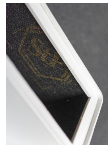
Zdj. 210. Wygłuszenie obudowy.
