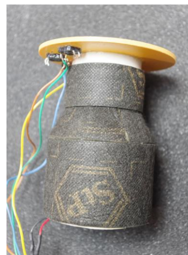
Zdj. 211. Wygłuszenie komory silnika.
