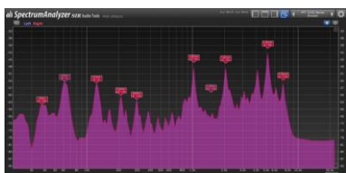
Zdj. 213. Widmo akustyczne dmuchawcy nr 6 przed wygłuszeniem.
