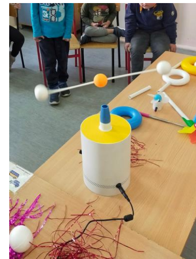
Zdj. 157. Lewitacja i ruch obrotowy trzech piłeczek połączonych osią.
