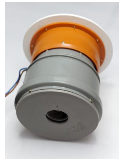
Zdj. 98. Komora wentylatora.
