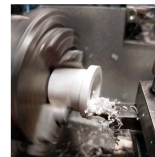
Zdj. 89. Toczenie kanału przepływu powietrza dmuchawy.
