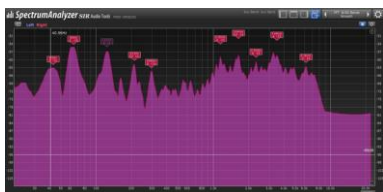
Zdj. 215. Widmo akustyczne dmuchawcy nr 7 przed wygłuszeniem.
