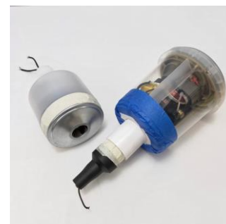
Zdj. 84. Dobór wielkości komory wentylatora.
