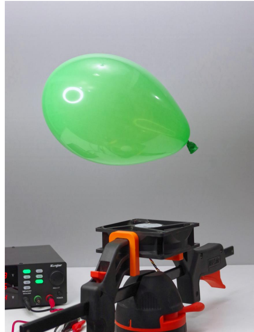
Zdj. 10. Balon w strumieniu wentylatora komputerowego.
