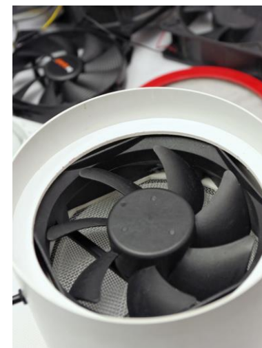
Zdj. 91. Wentylator osiowy dmuchawy.
