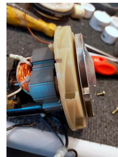
Zdj. 113. Wentylator ze zdjętą osłoną.
