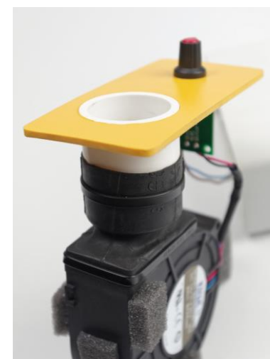
Zdj. 121. Elastyczne połączenie gumowe wentylatora z króćcem wylotowym.
