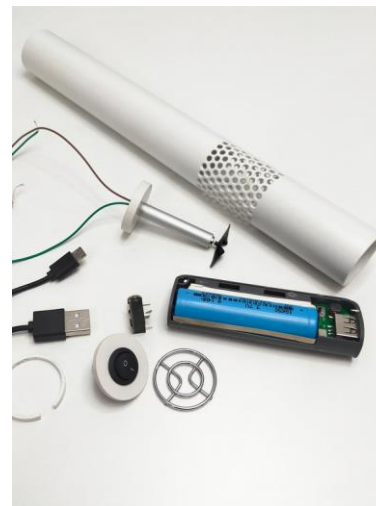
Zdj. 130. Widok wszystkich elementów dmuchawy.
