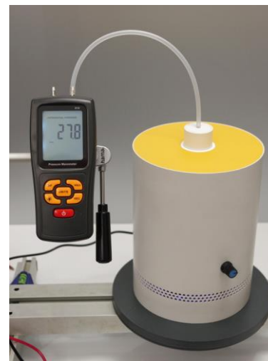
Zdj. 201. Pomiar ciśnienia statycznego.
