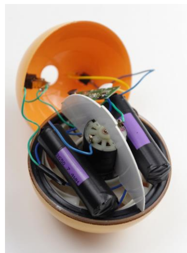
Zdj. 127. Dmuchawa przed założeniem górnej pokrywy.
