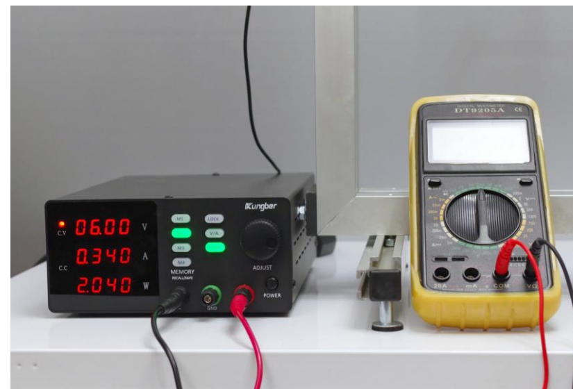
Zdj. 203. Pomiar parametrów elektrycznych dmuchawy.
